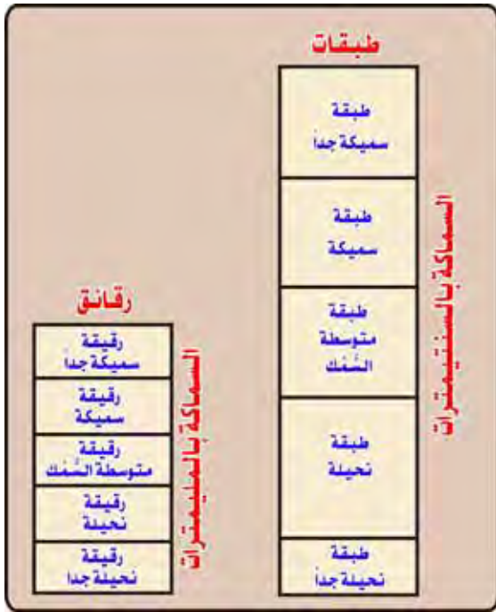
شكل T.11 رسمه توضح مسميات الطبقات والرقائق الطبقيّة حسب سماكتها Reineck & Singh, 1975
